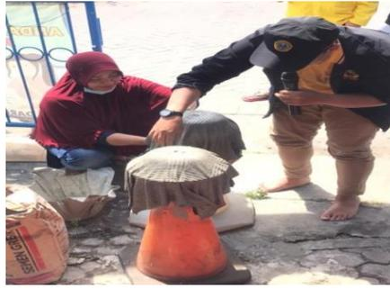
**Gambar 2 Proses pencetakan kain menggunakan ember**
