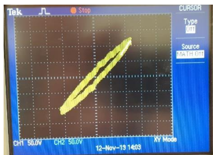
Gambar 12. Perbedaan Sudut Fasa Antara Tegangan Inverter Dan Jaringan Listrik PLN Sebesar 8.2°
