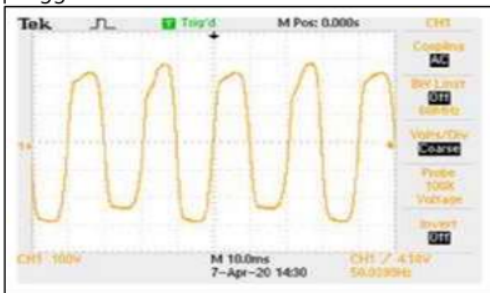
Gambar 16. Hasil Pengamatan Osiloskop Setelah Menggunakan Beban Lampu Led
