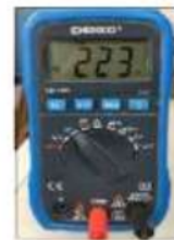
Gambar 13. Hasil Pengukuran Multimeter Tegangan SPWM
