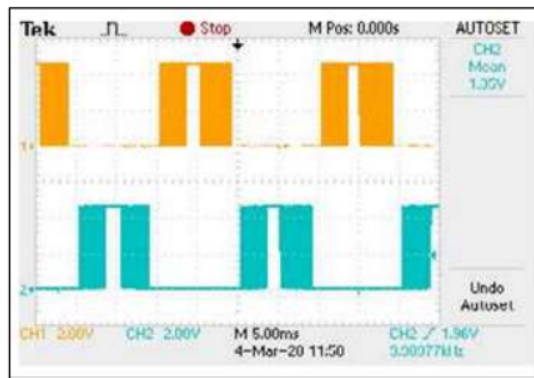
Gambar 7. Hasil Pengamatan Pembangkit SPWM Menggunakan Osiloskop
