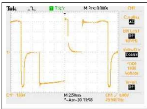
Gambar 10. Hasil Pengamatan Satu Periode Keluaran Inverter Square Wave Tanpa Beban Gambar 9 menunjukkan gelombang keluaran dari inverter berupa gelombang square wave dengan skala pengukuran 100x, sehingga terlihat jelas besar magnitude dan frekuensi yang terbaca adalah 50
