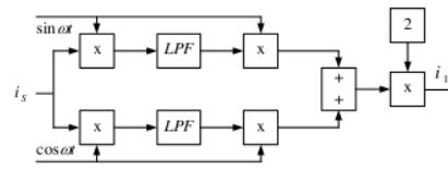
Gambar 8. Perhitungan komponen Fundamental
