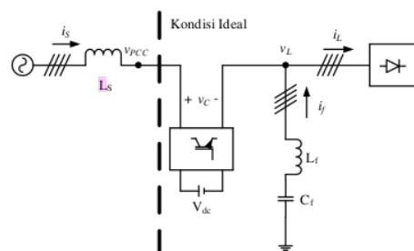
Gambar 6. Sistem dengan peralatan kompensasi
