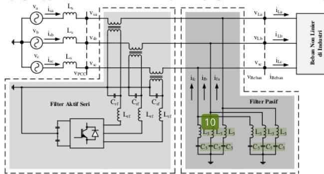
Gambar 12. Topologi rangkaian filter aktif seri dan filter pasif
