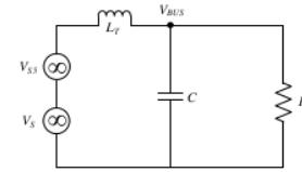
Gambar 11. Model rangkaian setara satu phasa beban industri
