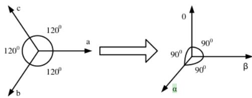
Gambar 3. Transformasi sistem referensi phasa (abc) ke sistem 0 $\alpha\beta$
