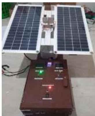
Gambar 5. Hasil desain solar tracker dua sumbu
