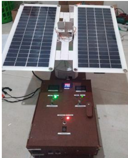
Gambar 5. Hasil desain solar tracker dua sumbu
