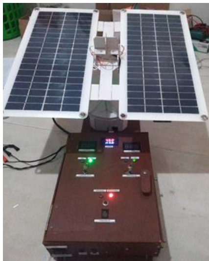
Gambar 5. Hasil desain solar tracker dua sumbu
