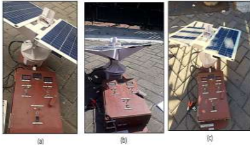
Gambar 6. Pengujian sistem tracker dua sumbu dinamis dan pengambilan data pada jam; (a) 09.00, (b) 12.00, dan (c) 15.00 WIB
