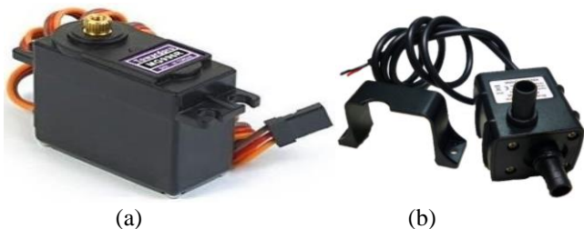
Gambar 6. Motor penggerak robot kapal dan untuk penyedot limbah minyak; (a) Motor Servo MG996R; (b) Motor Brushless DC Pump
