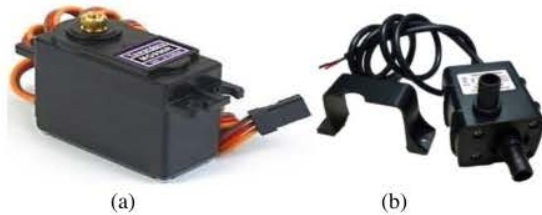
Gambar 6. Motor penggerak robot kapal dan untuk penyedot limbah minyak; (a) Motor Servo MG996R; (b) Motor Brushless DC Pump
