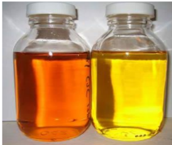
Gambar 4. Minyak Isolasi Transformator
