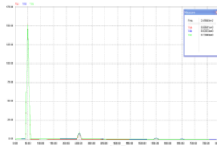
Gambar 9. Spektrum harmonisa tegangan input pada rangkaian berbeban non-linier tanpa filter aktif seri tiga fase dengan nilai L dan C tetap pada nilai R = 5 Ohm
