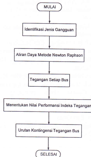
Gambar 2. Diagram alir analisis kontingensi tegangan bus menggunakan Metode Performansi Indeks
