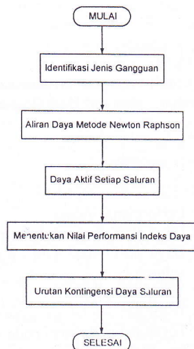
Gambar 3. Diagram alir analisis kontingensi daya saluran menggunakan Metode Performansi Indeks
