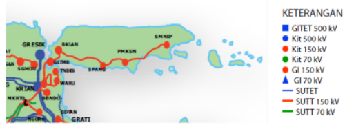
Gambar 11. Jaring Transmisi 150 kV Madura
