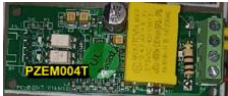
Gambar 3.7 Aplikasi Sensor tegangan pada kontroler
