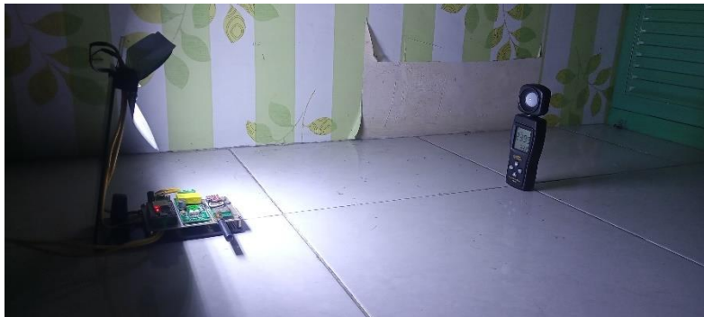
Gambar 4.15 pengambilan data intensitas cahaya pada jarak 50cm
