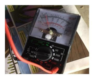
Gambar 4.23. Pengukuran Tegangan Menggunakan Avometer
