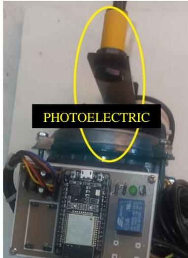
**Gambar 3.8** Aplikasi photoelectric untuk pengukuran kecepatan
