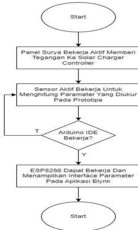
Gambar 3.2. Flowchart Sistem Monitoring berbasis aplikasi blynk
