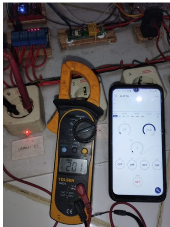
Gambar 10. Pengujian tegangan menggunakan Clamp-meter dan sensor PZEM-004t-Blynk
