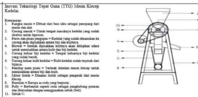
Gambar 2 : Inovasi teknologi tepat guna (TTG) mesin Klecep kedelai
