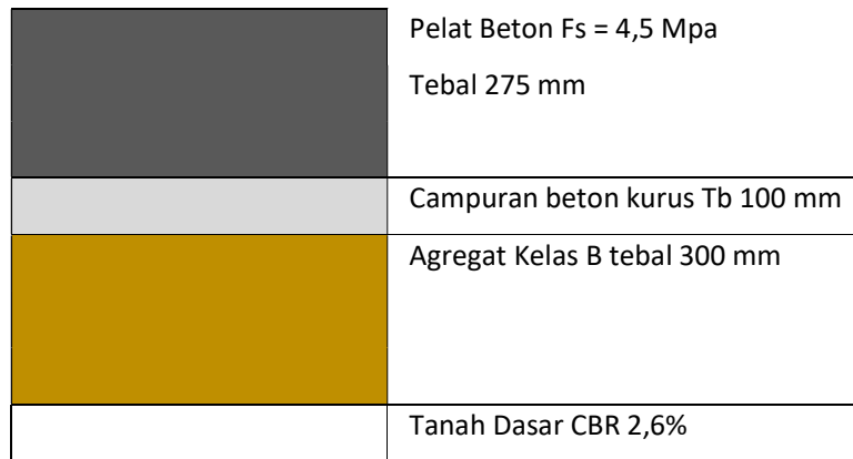
Gambar 4. 1 Struktur Perkerasan Kaku
