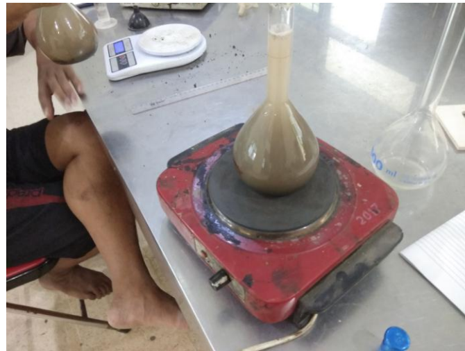
Dokumentasi Foto Pengujian Berat Jenis Tanah
