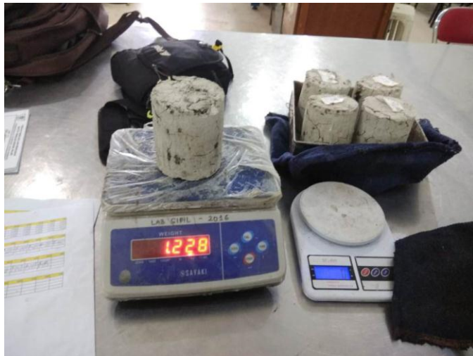
Dokumentasi Foto Pengujian Standart Proctor Campuran Kapur Tohor
